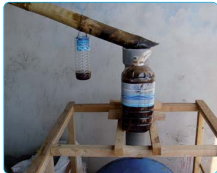
กระบอกไม้ไผ่ที่ทะลวงทำเป็นปล่องควัน และเจาะรูให้น้ำส้มออก
