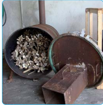
เตาเผาถ่านที่ทำจากถังน้ำมัน ขนาด 200 ลิตร
