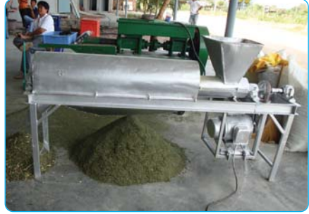
นำไบโอมันมาผ่านเครื่องร่อนขนาดเล็กเพื่อแยกส่วนกึ่งก้านและไบส่วนหยาบออก
