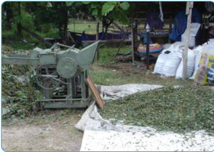
สับยอดและไบมันสำปะหลังด้วยเครื่องสับ
