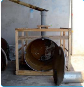
เตาเผาถ่านที่ทำจากถังน้ำมัน ขนาด 200 ลิตร
