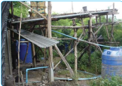
ปล่องควันที่ต่อมาจากเตาเผาถ่านหุ้มด้วย กระสอบชุบน้ำเย็น
