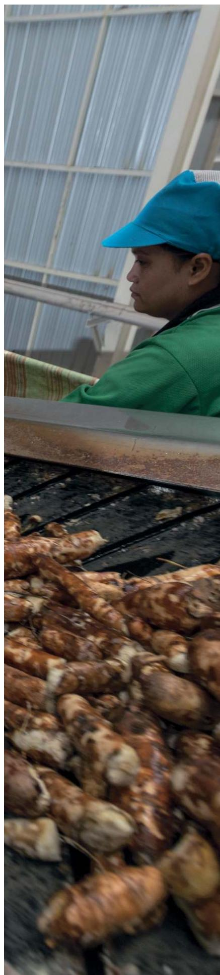
“มันสำปะหลัง” ที่เข้ากระบวนการอุตสาหกรรมแปรรูปแป้ง จะถูกล้างทำความสะอาด และนำเศษ根มันที่เหลือไปใช้ให้เกิดประโยชน์อีกรัง โดยโรงงานจะนำแป้งที่สูญเสียไปในระหว่างผลิตและอยู่ในน้ำเสียมาทำเป็นใบโถก๊าซ ซึ่งช่วยลดต้นทุนในการกำจัดน้ำเสีย
